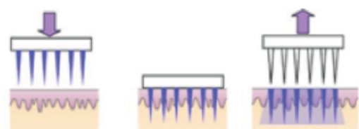
Figura 2. Esquematização do funcionamento de microagulhas: (i) microagulhas sólidas – são removidas intactas após perfurar a epiderme e, posteriormente, o fármaco é aplicado; (ii) microagulhas revestidas – o revestimento contendo o fármaco fica retido na epiderme após remoção do dispositivo; (iii) microagulhas dissolvíveis – as agulhas são formadas pela solução que sustenta o fármaco, perfuram a epiderme e se dissolvem no local de aplicação; (iv) microagulhas ocas – penetram a epiderme, a solução com fármaco é injetada e elas são retiradas. Adaptado de Arora e cols. 5 com permissão da Elsevier.
